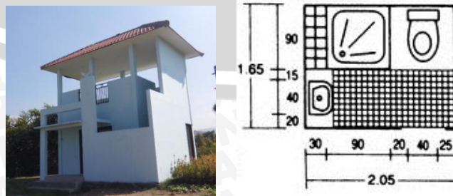
Gambar 4.36. Toilet Umum Pada Kawasan Studi & Standar Ukuran Toilet (Neufert 3 rd Edition)
