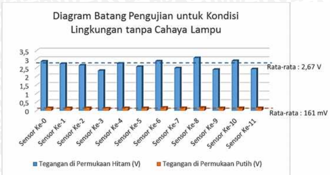
Gambar 4.2 Diagram Batang Hasil Pengujian Rangkaian Sensor Cahaya TCRT5000 untuk Kondisi Lingkungan tanpa Cahaya Lampu
