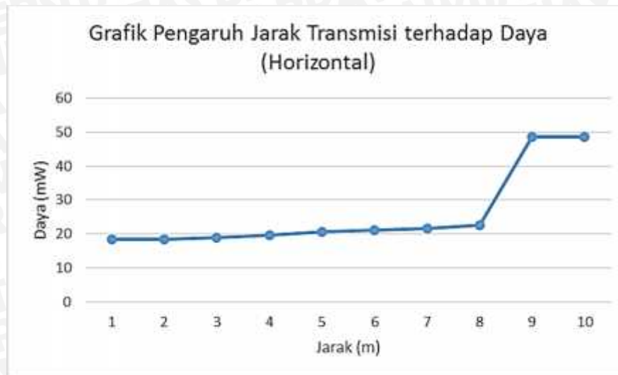
Gambar 4.6 Grafik Hasil Pengujian Daya HC-05 pada Posisi Horizontal
