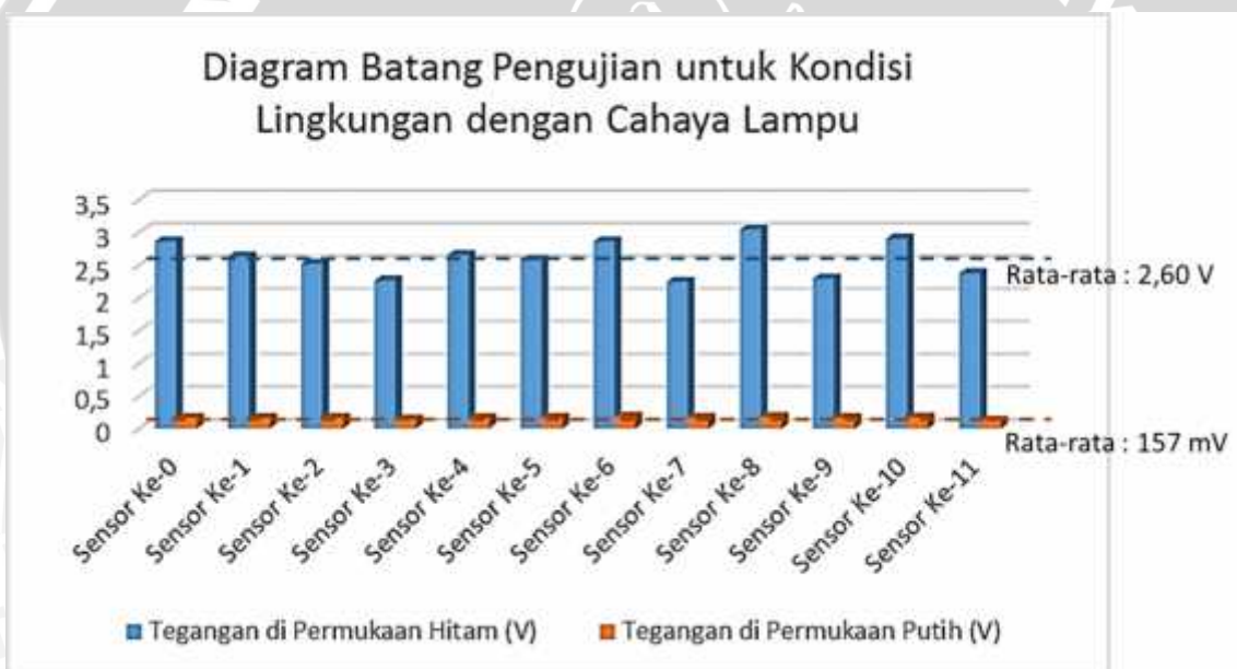
Gambar 4.3 Diagram Batang Hasil Pengujian Rangkaian Sensor Cahaya TCRT5000 untuk Kondisi Lingkungan dengan Cahaya Lampu
