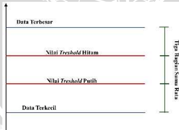
Gambar 3.11 Diagram Data-Data yang Didapatkan dari Proses Kalibrasi
