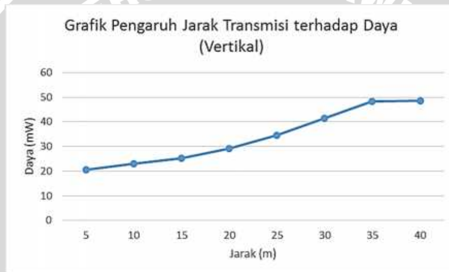
Gambar 4.7 Grafik Hasil Pengujian Daya HC-05 pada Posisi Vertikal
