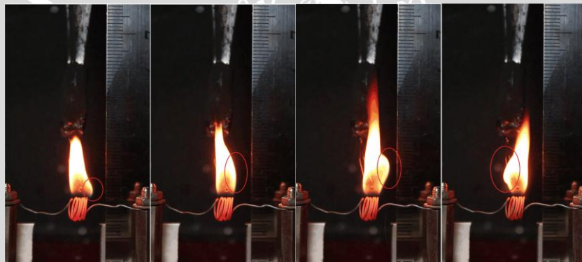
Gambar 4.11 Fenomena microexplosion pada biodiesel minyak jarak dengan 4% minyak cengkeh
