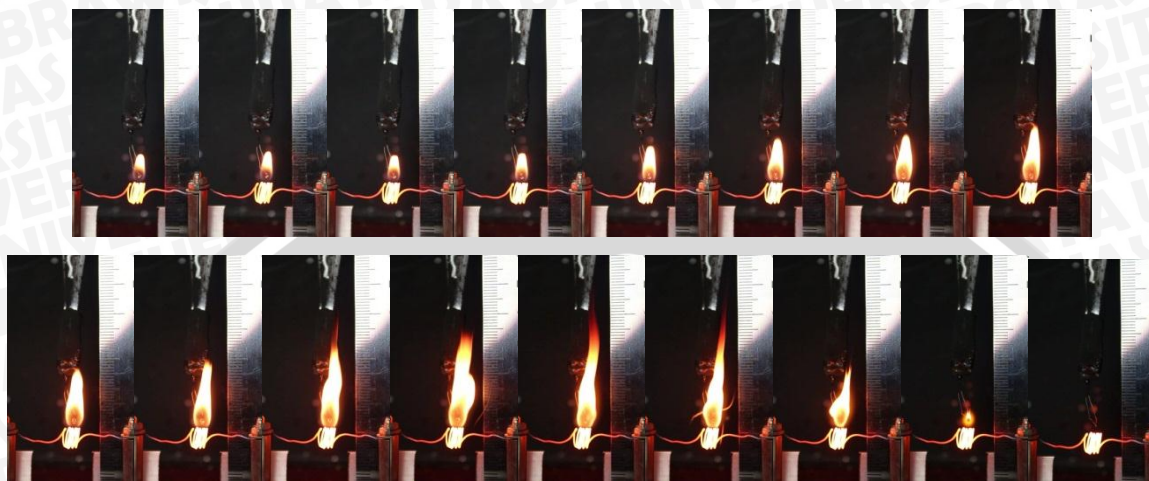
Gambar 4.4 Perubahan Dimensi Nyala Api Campuran Biodiesel Minyak Jarak dengan 1% Minyak Cengkeh
