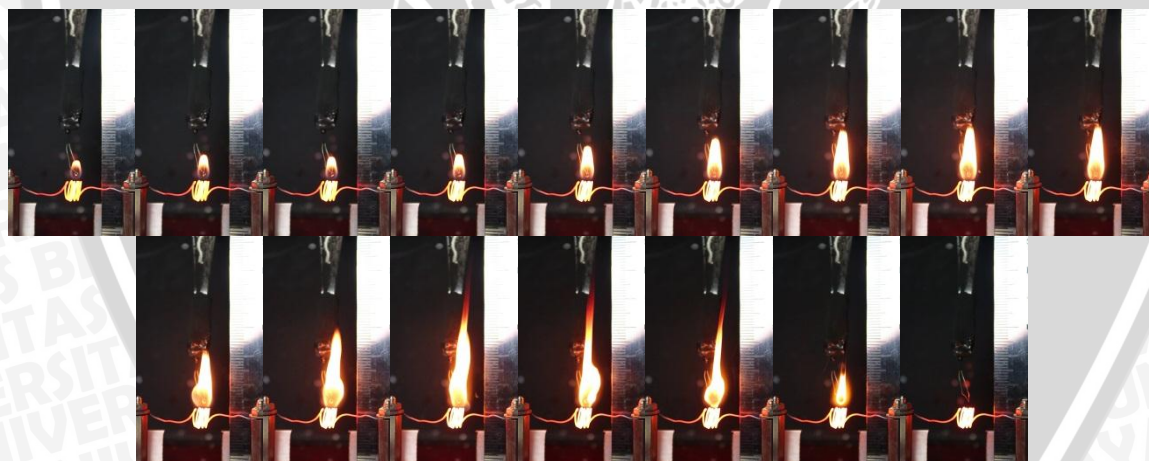
Gambar 4.5 Perubahan Dimensi Nyala Api Campuran Biodiesel Minyak Jarak dengan 2% Minyak Cengkeh
