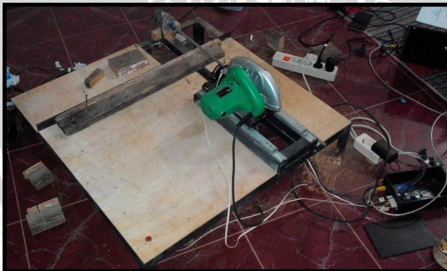
Foto Proses Pembuatan Pemotong Kayu
