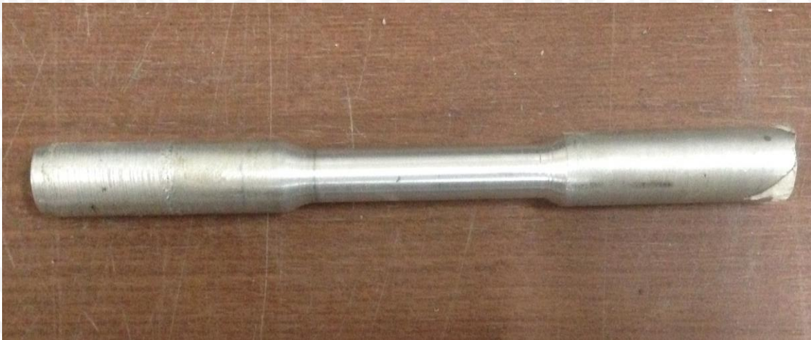
Gambar 3.9 Benda kerja setelah dibentuk uji tarik Sumber: Dokumen Pribadi (2016)
