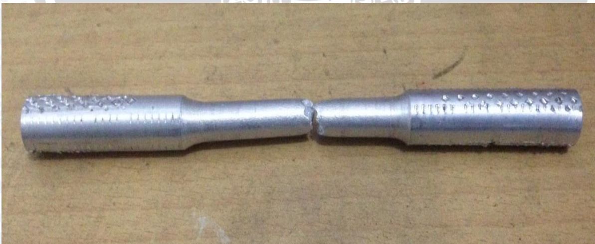
Gambar 3.10 Benda kerja setelah diuji tarik Sumber: Dokumen Pribadi (2016)
