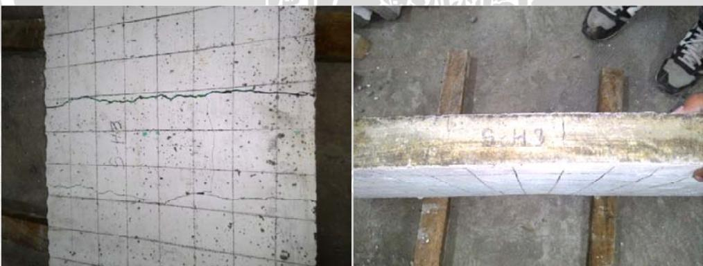
Hasil pengujian plat lapis *styrofoam* SH-3
