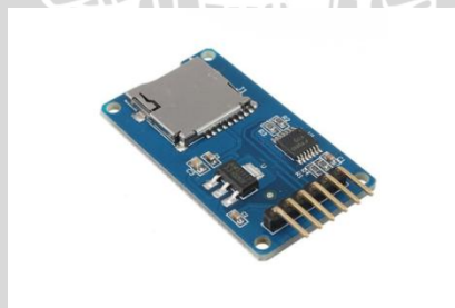
Gambar 2.6 IC Data Logger Slot micro sd
