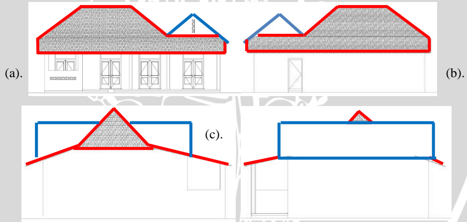
Gambar 4.75. Bentuk dan jenis atap kasus rumah 12 (a). Tampak depan (b). Tampak belakang (c) (d). Tampak samping.
