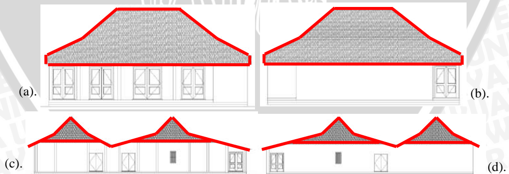
Gambar 4.27. Bentuk dan jenis atap kasus rumah 4 (a). Tampak depan (b). Tampak belakang (c) (d). Tampak samping.
