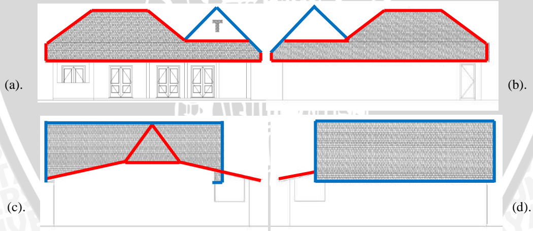
Gambar 4.97. Bentuk dan jenis atap kasus rumah 16 (a). Tampak depan (b). Tampak belakang (c) (d). Tampak samping.
