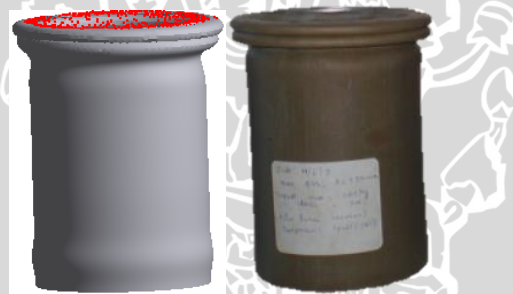
Gambar 4.1 : Verifikasi hasil uji Crash Box melalui (a) Simulasi (b) Eksperimental
