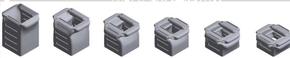
Gambar 4.4 : Proses Deformasi Crash Box model ke-3
