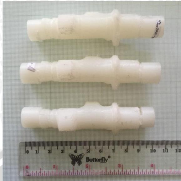
Gambar 4.2 produk *camshaft* hasil permesinan
