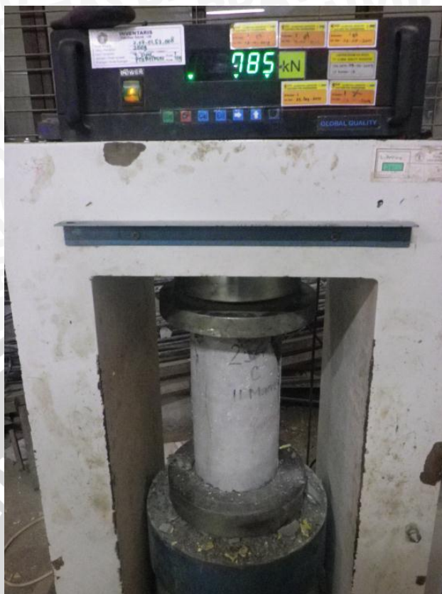
Gambar 9. Pengujian kuat tekan
