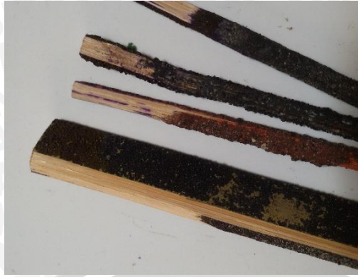
Gambar 4.2 Pengujian resapan bambu terhadap air
