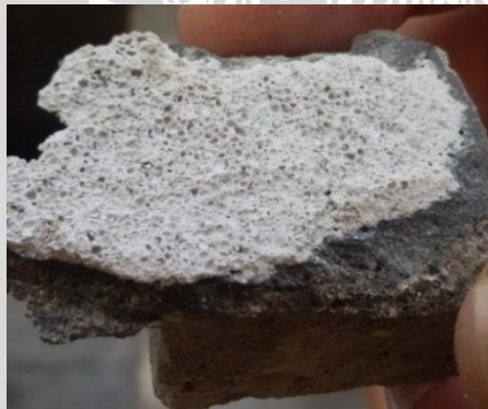
Gambar 4.3 Pengujian lekatan bata ringan dan beton
