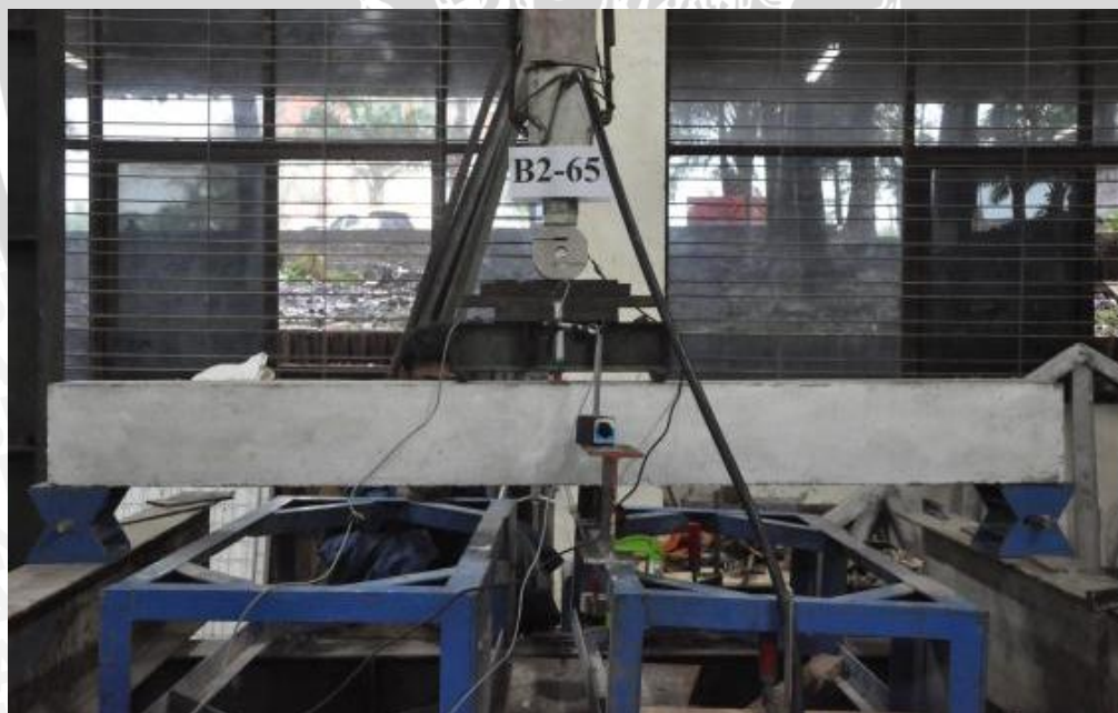
Gambar 10. Setting alat untuk pengujian kuat lentur
