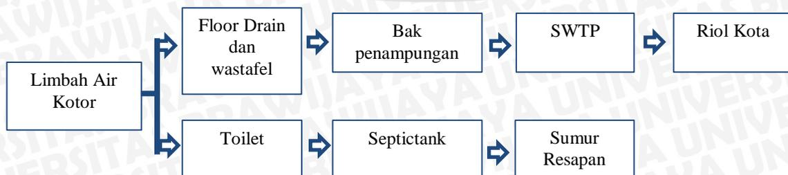
Gambar 4.98 Diagram pembuangan air kotor
