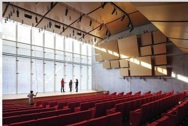
Gambar 4.52 Contoh Ceiling *Wood Fibre Cement Composites* pada plafond auditorium
