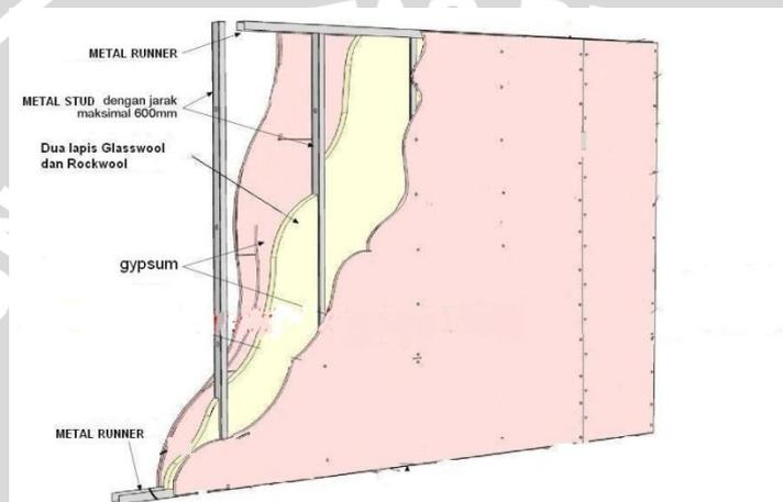
Gambar 4.51 Dinding/partisi dengan lapisan *Glasswool*
