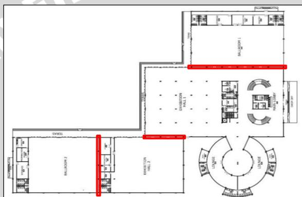
Gambar 4.80 Letak Dilatasi Kolom
