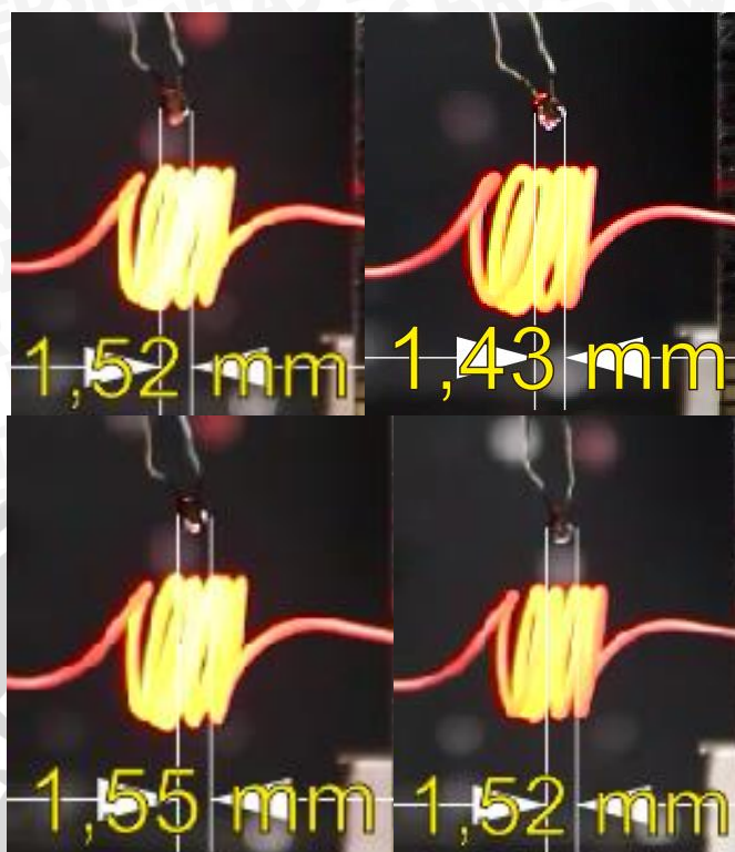
Gambar 4.1 Ukuran Droplet Biodiesel Minyak Nabati dengan Campuran Minyak Cengkeh 3%, (a) Biodiesel Minyak Jarak, (b) Biodiesel Minyak Kelapa, (c) Biodiesel Minyak Biji Bunga Matahari, (d) Biodiesel Minyak Jagung
