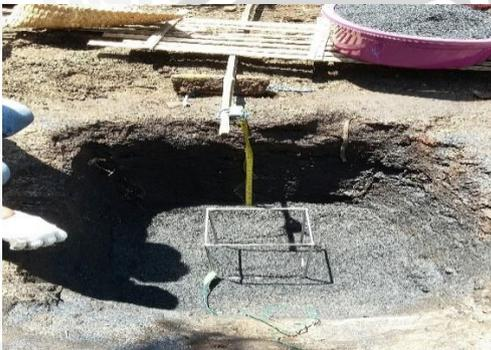
Awalnya diberikan media sisipan kemudian diletakkan elektroda rangka balok. Kabel warna hijau dihubungkan antara objek uji dan alat ukur.
