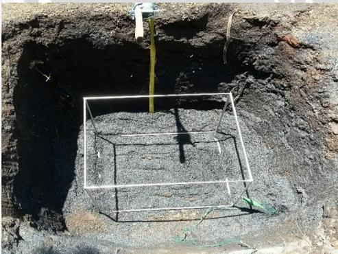
Awalnya diberikan media sisipan kemudian diletakkan elektroda rangka balok. Kabel warna hijau dihubungkan antara objek uji dan alat ukur.
