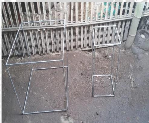
Objek Uji berupa 2 elektroda berbentuk rangka balok dan rangka kubus. Dimensi masing-masing adalah 25 cm x 25 cm x 50 cm untuk elektroda rangka balok dan 50 cm x 50 cm x 50 cm untuk elektroda rangka kubus.
