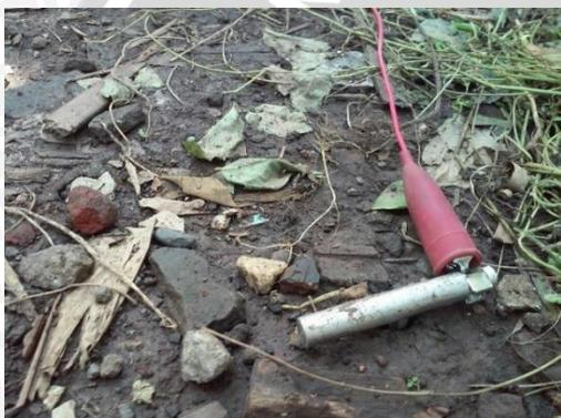
Kabel warna merah pada alat ukur dihubungkan dengan elektroda bantu 1 dengan jarak 10m.
