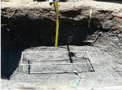
Elektroda rangka balok diletakkan secara horizontal. Kabel warna hijau dihubungkan antara objek uji dan alat ukur.
