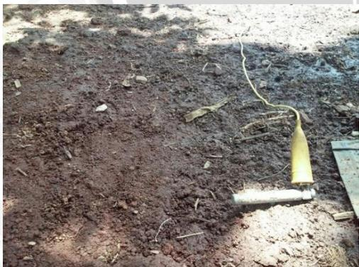
Kabel warna kuning pada alat ukur dihubungkan dengan elektroda bantu 2 dengan jarak 5m.
