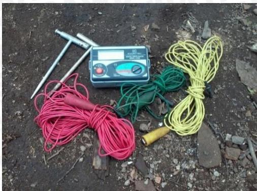
Alat ukur yang digunakan *digital earth tester* seri 4105A
