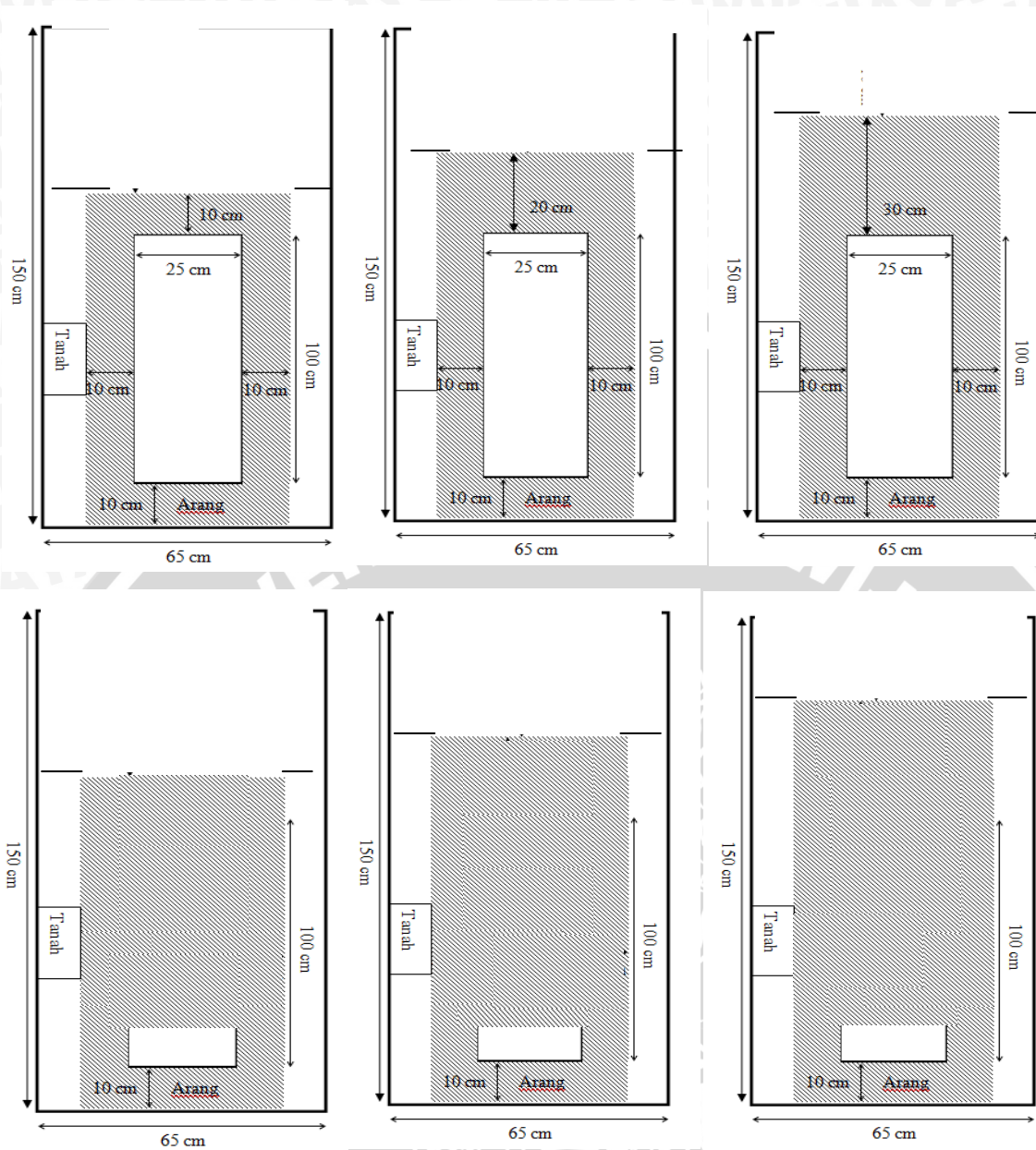
Gambar 3.3 sketsa arang, elektroda dan tanah
