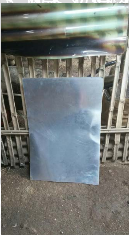
Gambar 2. Elektroda Pelat B Berukuran 50cm x 75cm
