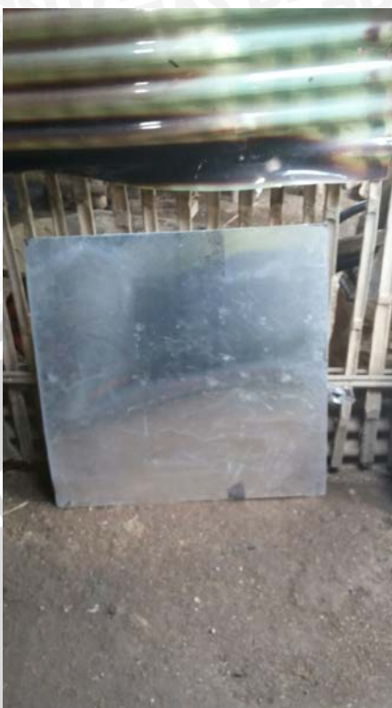
Gambar 1. Elektroda Pelat A Berukuran 50cm x 50cm
