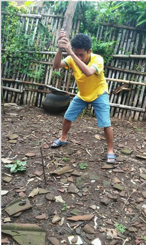
Gambar 6. Penanaman elektroda batang untuk pengukuran resistivitas tanah
