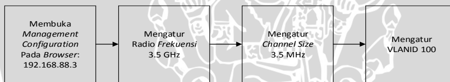
Gambar 4.7 Konfigurasi pada Base Station .
