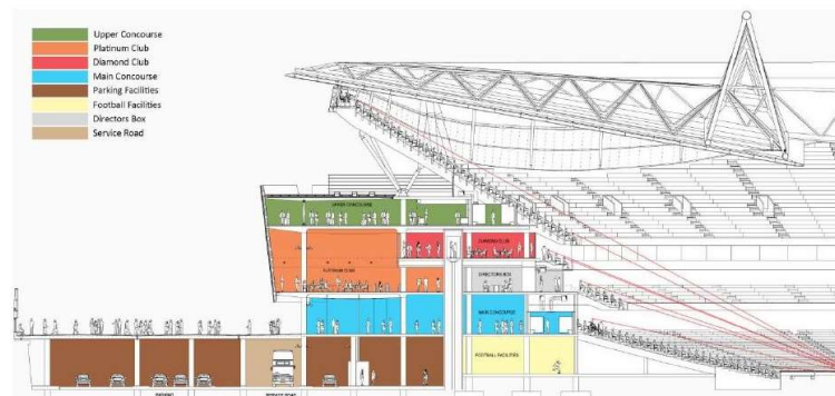
Gambar 2.25 Potongan melintang stadion Emirates memperlihatkan ruang dalam stadion
