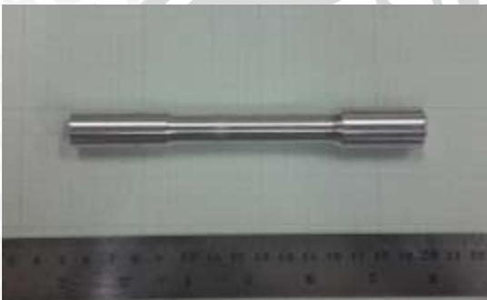
Gambar spesimen uji puntir
