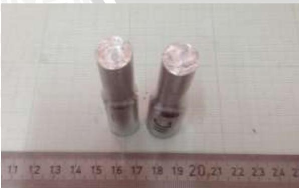
Gambar spesimen patahan (tampak berdiri)
