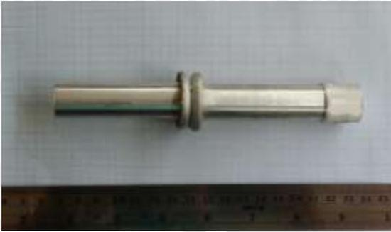
Gambar spesimen hasil pengelasan
