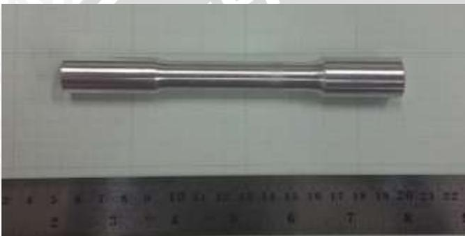
Gambar spesimen uji puntir
