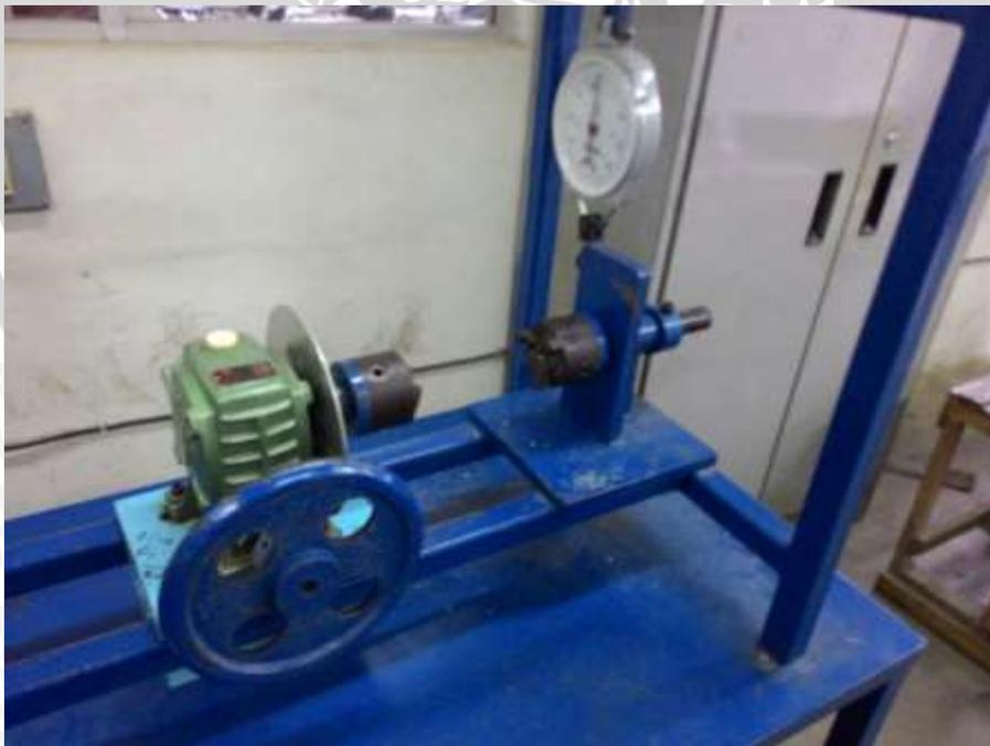
Gambar 3.3 Mesin uji puntir
