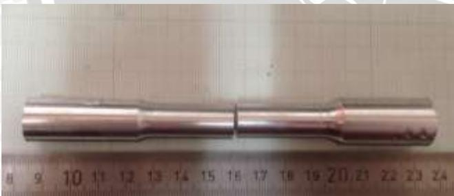
Gambar spesimen patahan (tampak tidur)
