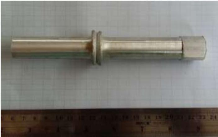
Gambar spesimen hasil pengelasan
