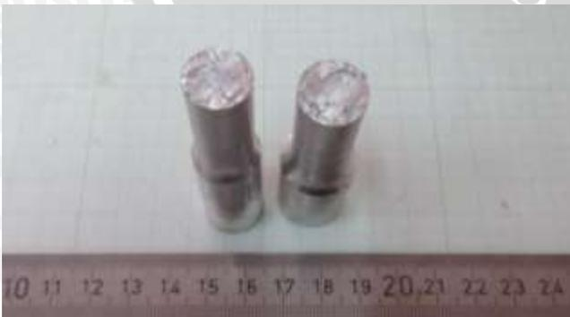
Gambar spesimen patahan (tampak berdiri)
