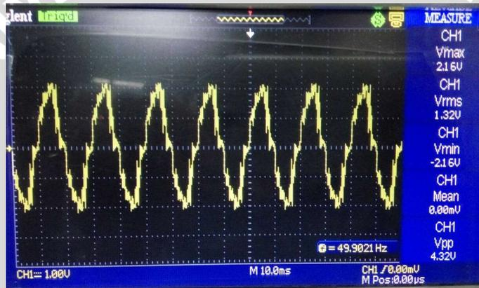
Gambar 4.6 Sinyal sinusoida tegangan keluaran dari sensor arus
