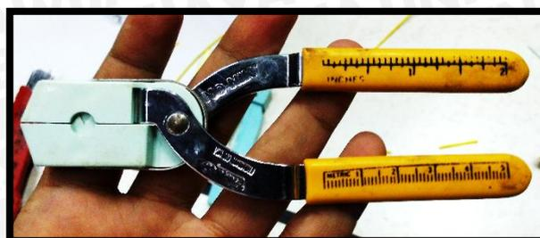
Gambar 4.7 *Stripper* kabel serat optik
