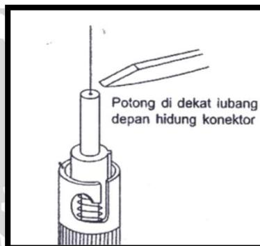
Gambar 4.13 Cara memotong kabel inti serat optik
