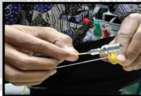
Gambar 4.11 Pemasangan kabel serat optik dan konektor ST
