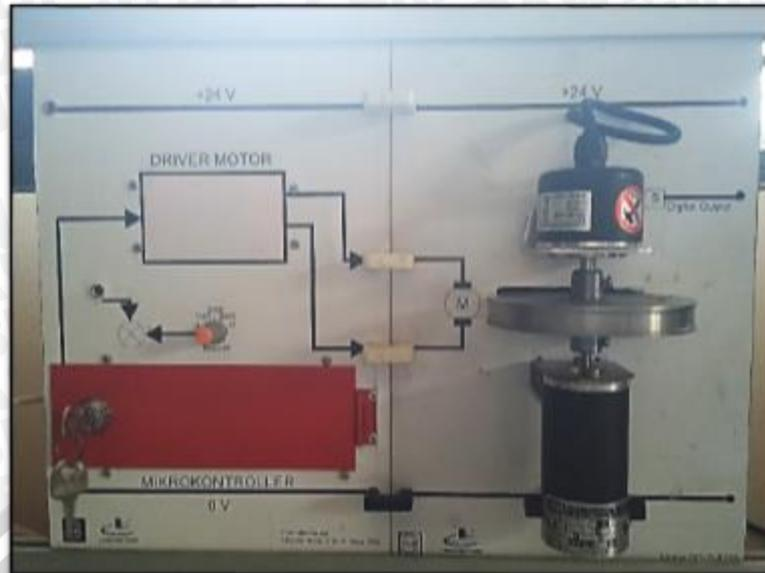
Foto modul mikrokontroler, driver, motor DC dan rotary encoder
