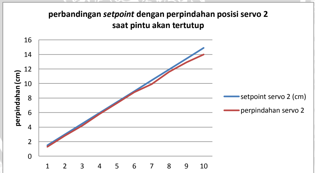
Gambar 4.24 Grafik perbandingan setpoint dengan perpindahan posisi servo 2 pada GUI saat pintu akan tertutup
