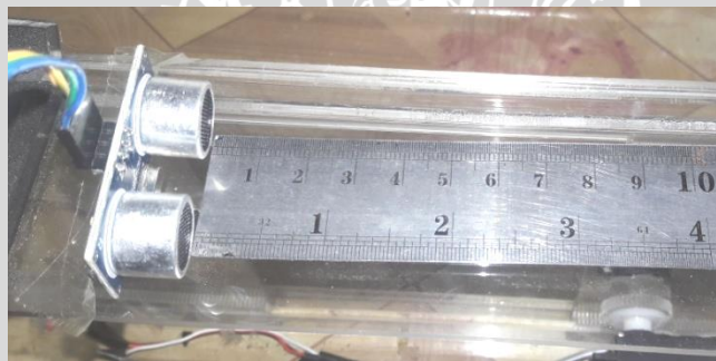
Gambar 4.1 Pengujian sensor ultrasonik HC-SR04
