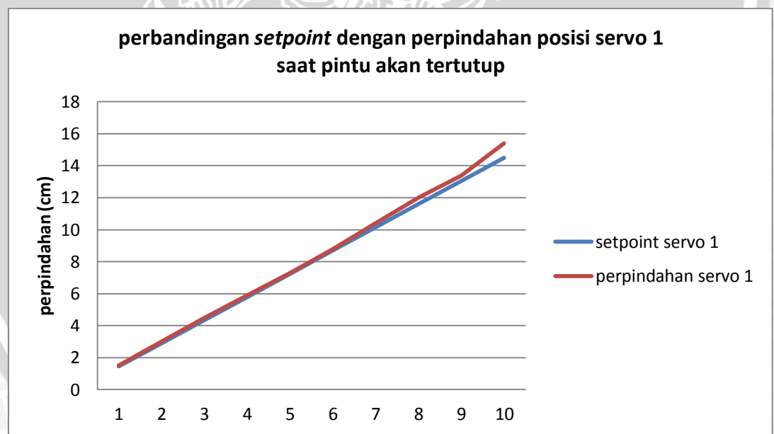
Gambar 4.22 Grafik perbandingan setpoint dengan perpindahan posisi servo 1 pada GUI saat pintu akan tertutup
