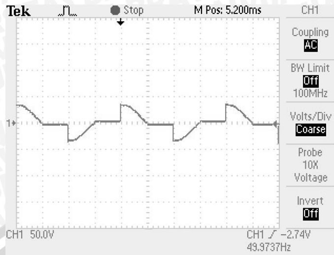
Gambar 5.7 Bentuk gelombang Keluaran TRIAC dengan PWM 32
