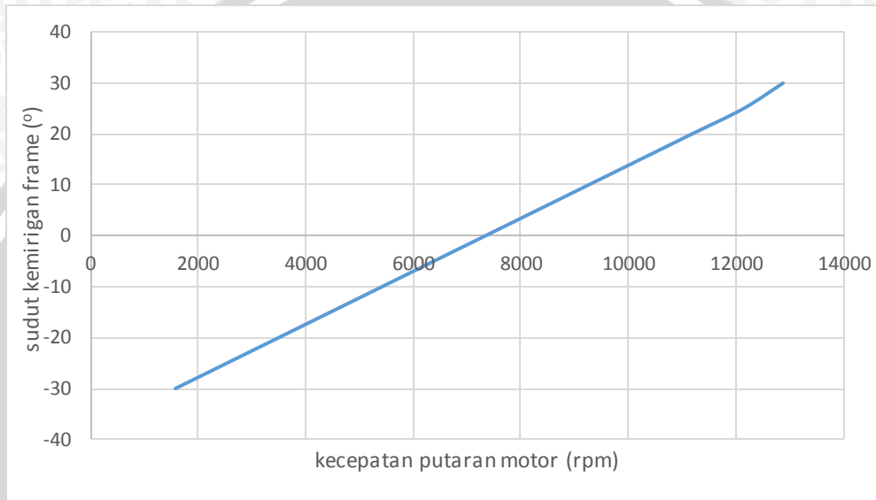
Gambar 5.4 Grafik perbandingan antara kecepatan putaran motor BLDC terhadap sudut kemiringan frame
