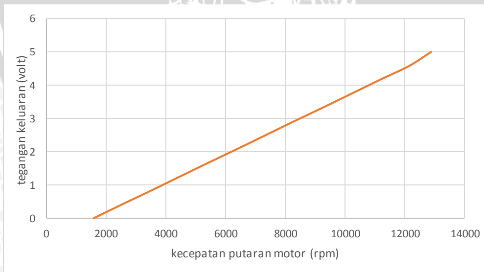
Gambar 5.5 Grafik perbandingan antara kecepatan putaran motor BLDC terhadap tegangan keluaran sensor
