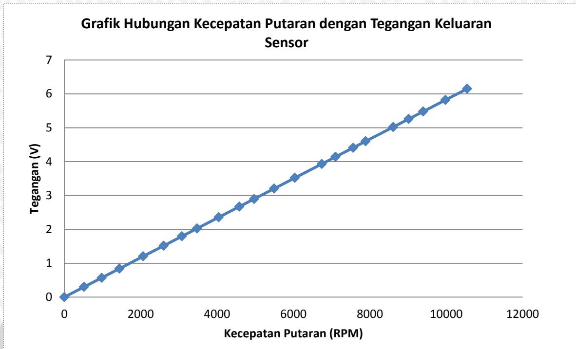
Gambar 5. 2 Grafik Hubungan Kecepatan Putaran Propeller dengan Tegangan Keluaran Sensor
