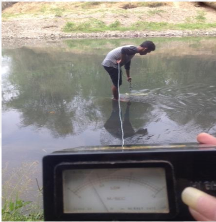
Gambar 4.8 Proses Pengukuran Kecepatan air sungai menggunakan Currentmeter Sumber : Dokumentasi Lapangan
