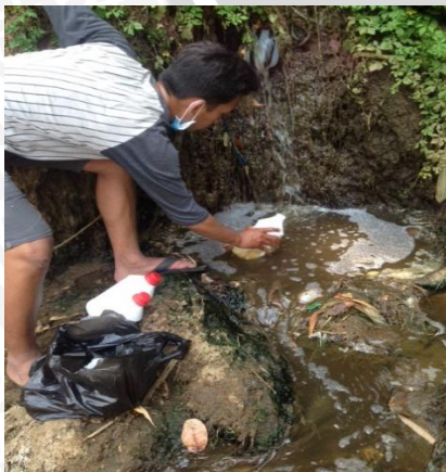
Gambar 4.12 Pengambilan sampel pada Output IPAL RPH Sumber : Dokumentasi Lapangan
