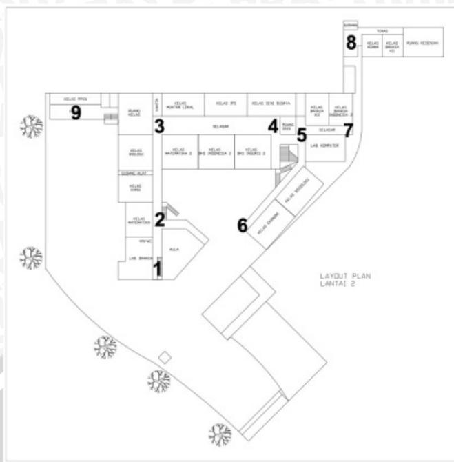
Gambar 4.6 Titik – titik pengukuran suhu, kelembaban dan kecepatan udara pada lantai 2
