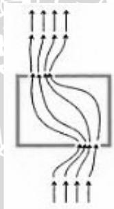
Gambar 2.11 inlet dan outlet bersilangan pada sisi berhadapan
