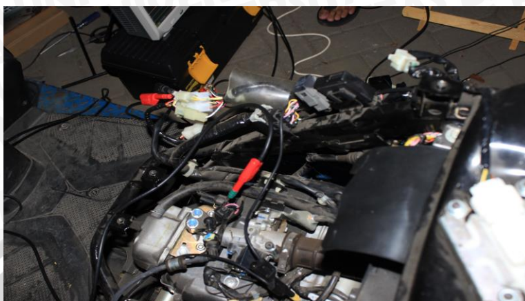
Pemasangan Probe Keseluruhan
