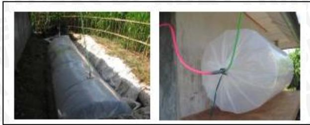
Gambar 2. 3 Desain Digester Tipe Plastik (Reaktor Balon)
