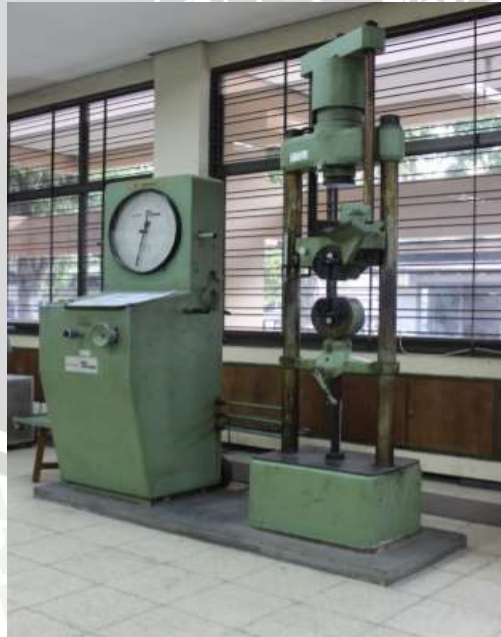
Gambar 3.5 Mesin Uji Tekan
