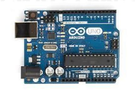
Gambar 5.1 Modul Arduino Uno (Perancangan)
