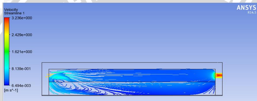
Gambar 4.5 Gambar garis alur kecepatan porous media baja Sumber : Ansys ® Workbench 14,5
