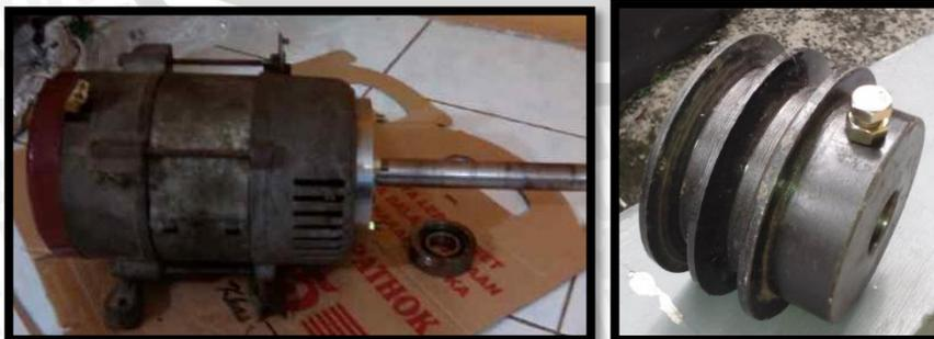
Gambar 4.7 Generator dan Pulley Baru untuk Pengujian PLTP
