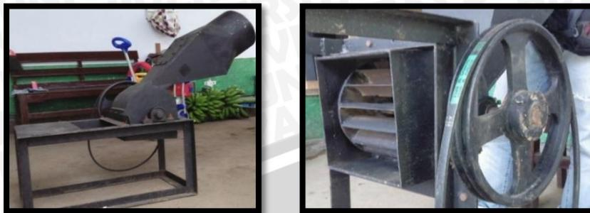
Gambar 4.4 PLTPH yang menggunakan turbin air *cross flow* untuk pengujian
