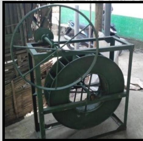
Gambar 4.1 PLTPH untuk Pengujian yang Menggunakan Turbin Air Jenis Pelton
