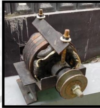
Gambar 4.6 Generator Buatan Pak Andum Untuk Pltph Turbin Air Jenis *Cross Flow*
