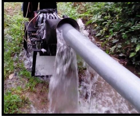
Gambar 4.9. Air yang Masuk ke Corong Turbin Air Jenis Cross Flow
