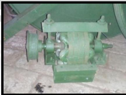
Gambar 4.3 Generator buatan Pak Andum untuk PLTPH turbin air jenis pelton
