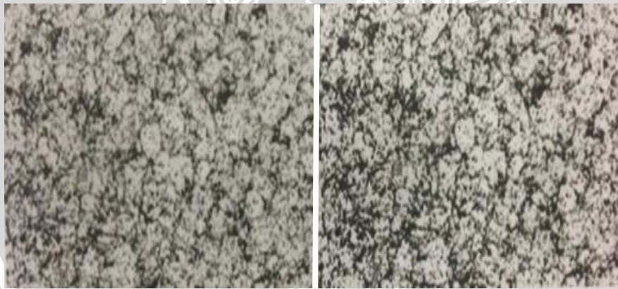
Gambar 2.18 kiri: morfologi aluminium dengan diameter penyinaran kecil & kanan: morfologi aluminium dengan diameter penyinaran besar. Sumber: Hafner (2007:10)
