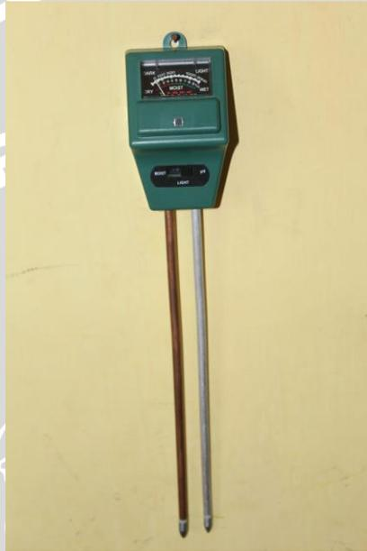
Gambar 4.11 pH meter tanah
