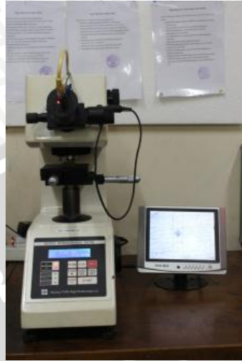
Gambar 3.4 Mesin Uji Kekerasan Permukaan Micro Vickers Sumber : Laboratorium Uji Material Mesin Universitas Brawijaya
