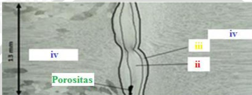
Gambar 4.15 Foto Makrostruktur Sudut *Chamfer* 11,5°, *Friction Time* 45 detik
