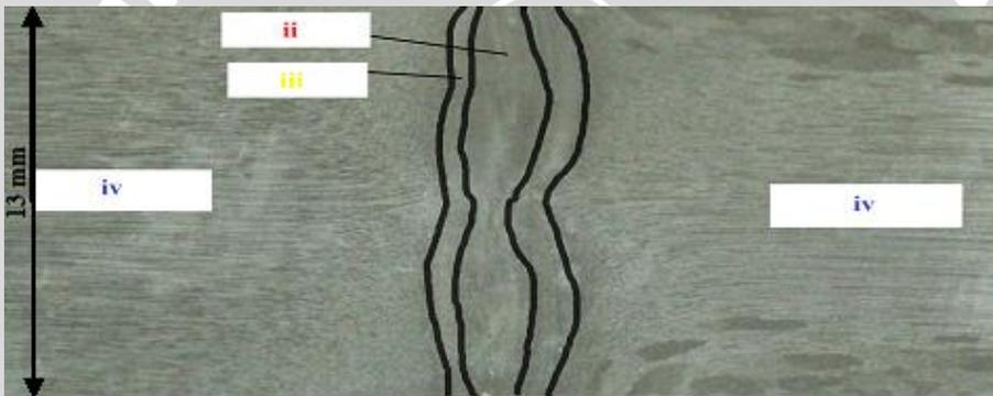
Gambar 4.3 Foto Makrostruktur Sudut *Chamfer*  $0^\circ$ , *Friction Time* 50 detik
