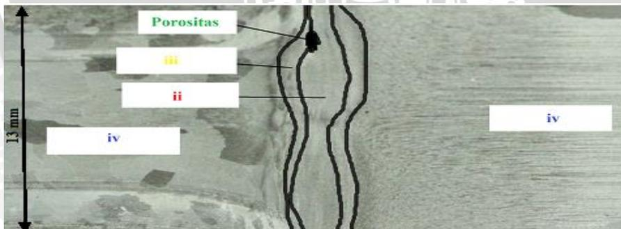
Gambar 4.7 Foto Makrostruktur Sudut *Chamfer* 11.5°, *Friction Time* 55 detik
