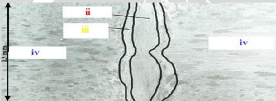
Gambar 4.6 Foto Makrostruktur Sudut *Chamfer* 11.5°, *Friction Time* 50 detik
