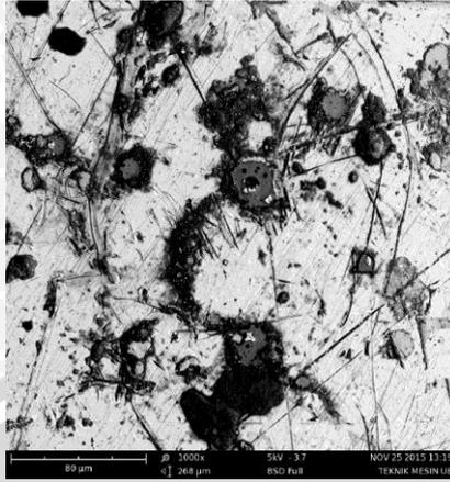
Gambar 4.4 Spesimen dengan variasi tekanan *chamber* 200 mTorr (perbesaran 1000x)
