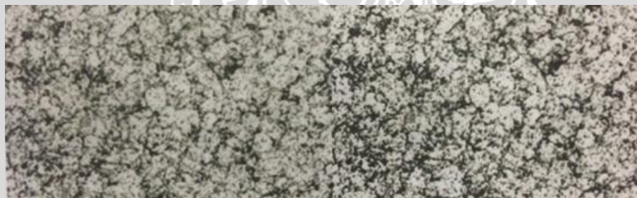
Gambar 2.18 kiri: morfologi aluminium dengan diameter penyinaran kecil & kanan: morfologi aluminium dengan diameter penyinaran besar. Sumber: Hafner (2007:10)
