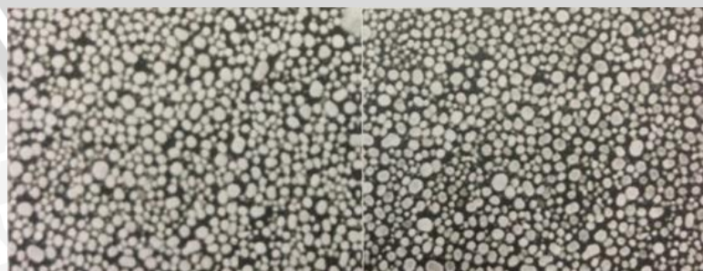
Gambar 2.16 kiri: morfologi emas dengan kecepatan penyinaran 5 kV & kanan: morfologi emas dengan kecepatan penyinaran 25 kV. Sumber: Hafner (2007:9)
