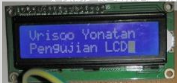
Gambar 4.3 Tampilan pengujian rangkaian LCD
