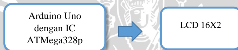
Gambar 4.2 Blok diagram pengujian LCD
