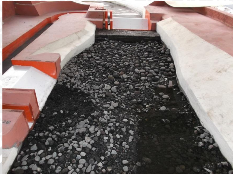
Gambar 3.6. Dasar Sungai pada Model Fisik Hilir Bendung Menggunakan Movable Bed
