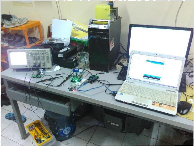
Gambar 7 Pengujian tegangan pada proses transmisi data
