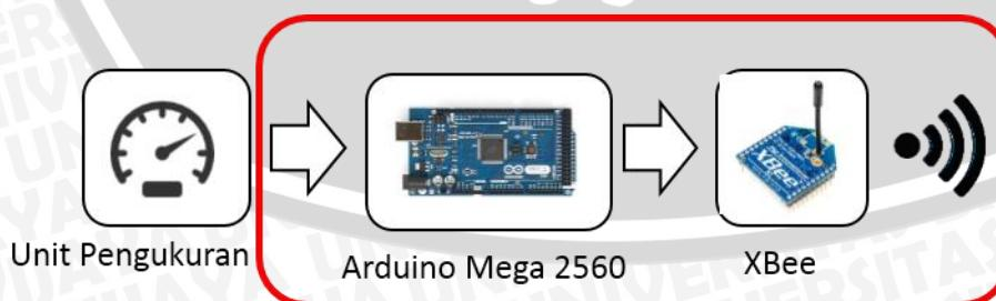
Gambar 3.2 Diagram blok sistem pada sebuah *slave* (*single node*).
