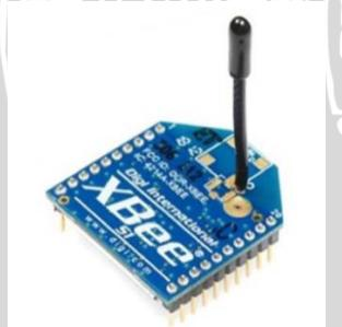
Gambar 2. 6 Modul XBee
