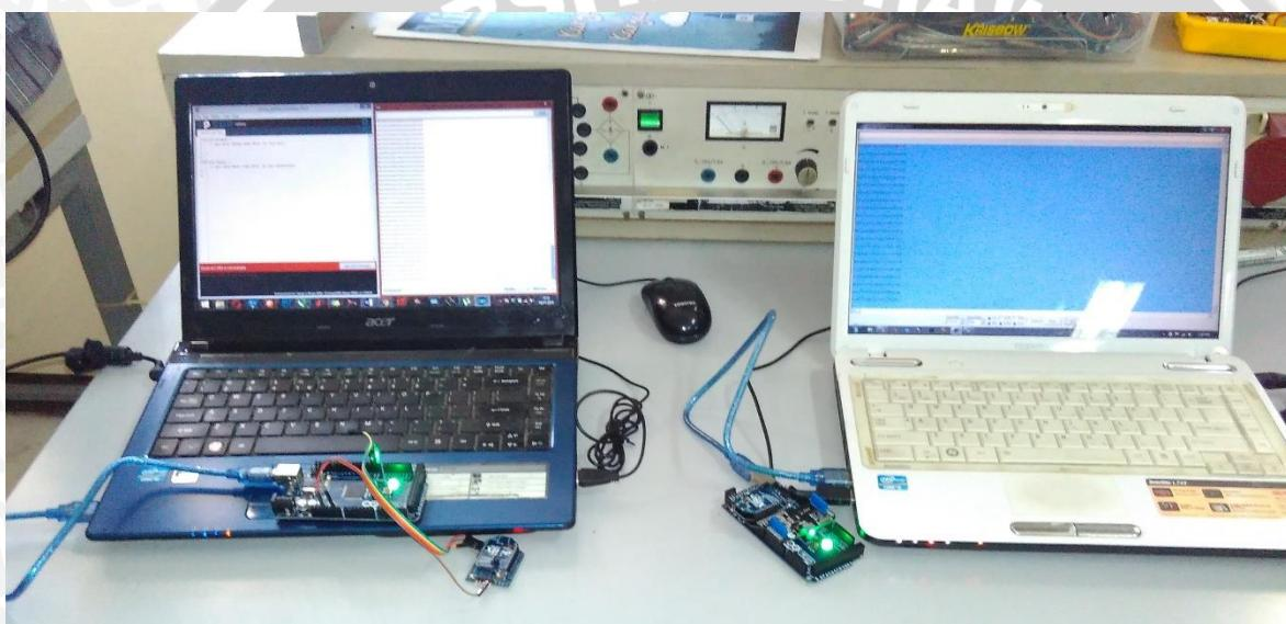
Gambar 4. 2 *Master* dan *slave* yang digunakan pada pengujian jarak dan halangan pada transmisi data
