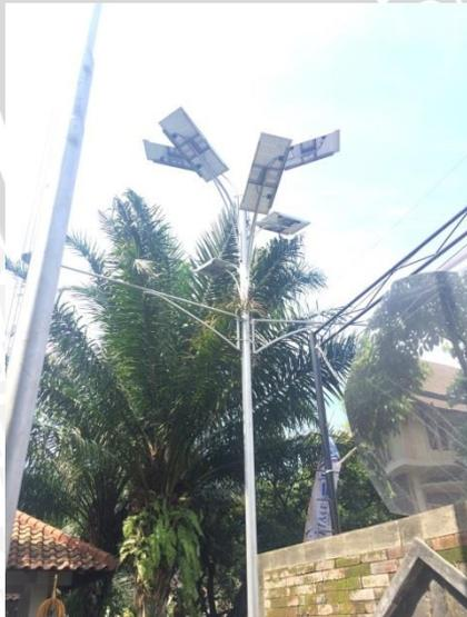
**Gambar 4.4** Solar panel untuk penerangan buatan pada malam hari
