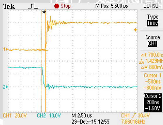
Gambar 5.9 Bentuk gelombang antara dead time high side dan low side
