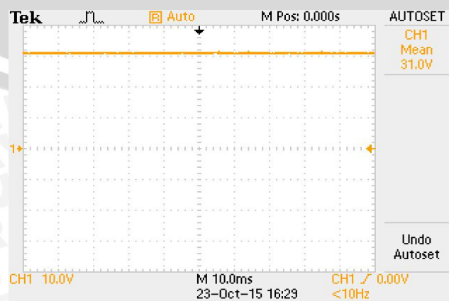
Gambar 5.4 Bentuk Gelombang Sesudah difilter Kapasitor
