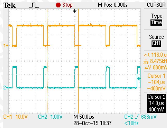
Gambar 5.7 Bentuk gelombang antara high side dan low side
