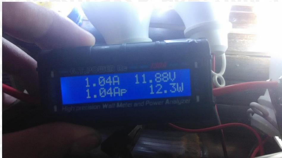
Gambar 3 Foto pengujian dengan *wattmeter*
