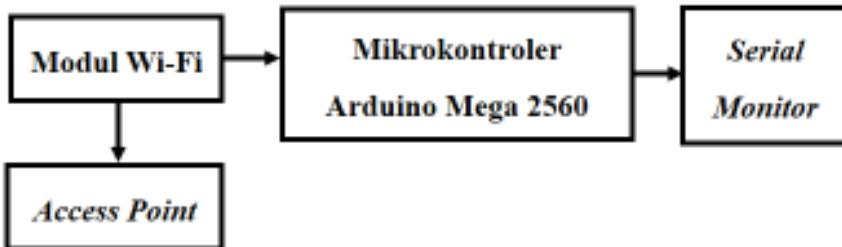
Gambar 4.6 Diagram blok pengujian modul *Wi-Fi*.
