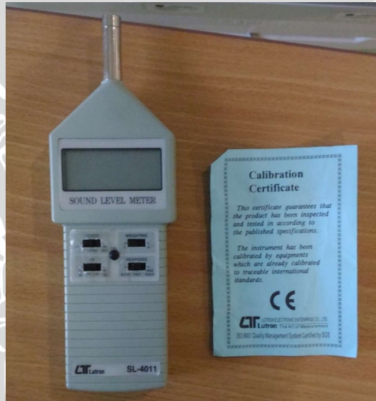
Gambar 3.4 Soundmeter yang digunakan dalam penelitian dan sertifikat kalibrasi alat
