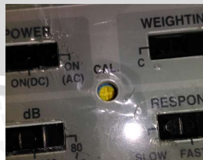
Gambar 3.5 Sekrup pengatur kalibrasi pada soundmeter yang digunakan
