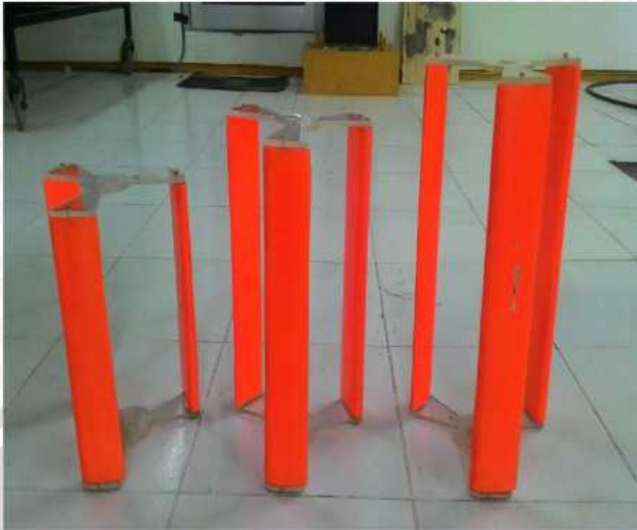
Gambar 3.5 Turbin Air Darrieus Tinggi 25 cm, 30 cm dan 35cm
