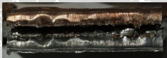
**Gambar 6** Foto Makro Spesimen Setelah Uji Tarik Sudut Pengelas  $-2^{\circ}$
