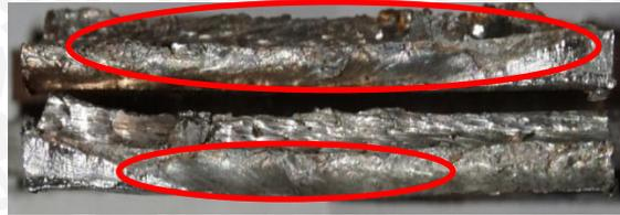
**Gambar 9** Foto Makro Spesimen Setelah Uji Tarik Sudut pengelasan 4°
