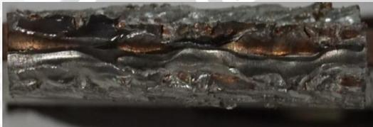
**Gambar 8** Foto Makro Spesimen Setelah Uji Tarik Sudut Pengelasan 2°
